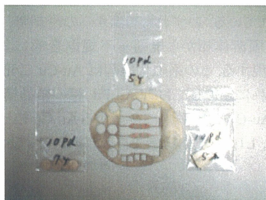
図4 放電加工後の試料外観
