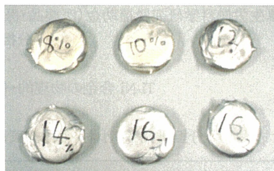
図2 アルゴンアーク溶解で溶製したボタン状インゴット
