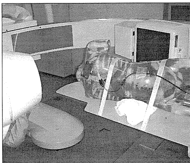
図 2 実験 1-1 および 1-2 の機器の設置と位置関係 ファントム前面から X線が照射される。背面に見えるのが FPD (flat panel detector)。
