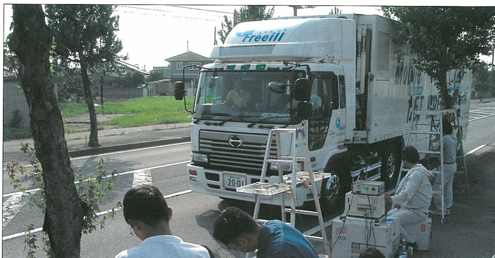
写真3 トラック走行実験風景 手前がファントムによる測定チーム。奥が磁力線測定チーム。
