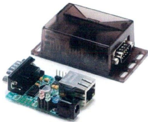
図7. 使用した輸液ポンプ状態検知送信装置
