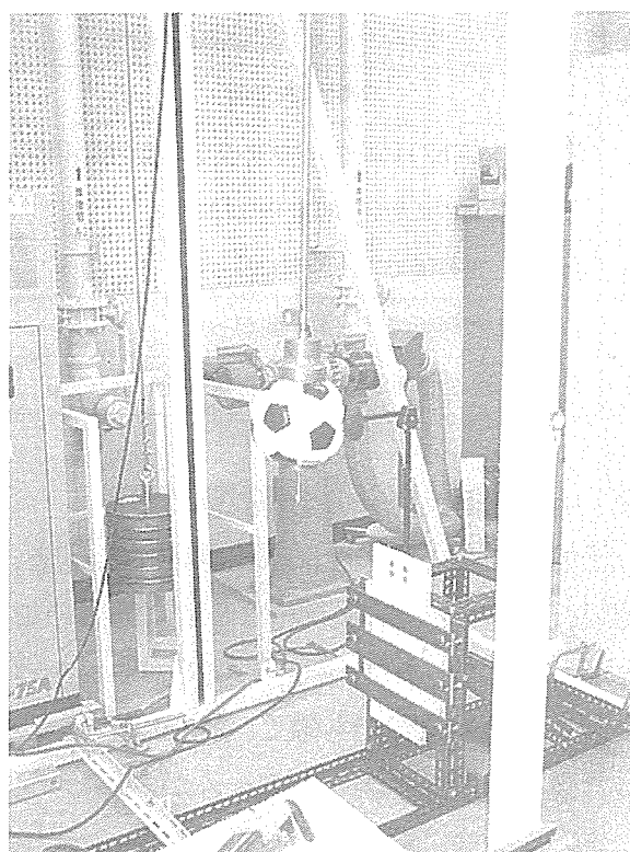
図9 頭部支持部の衝撃試験
