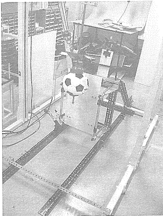
図1 1 背支持部の衝撃予備試験 (ISOの試験方法)
