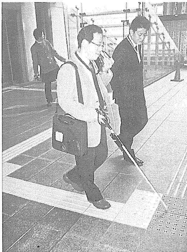
図2 障害者等ITバリアフリープロジェクト実証実験の現地体験（東大工学部2号館内） 点字ブロックに埋め込まれたICタグからの情報を音声で聞くため、装置を耳に近づけている
