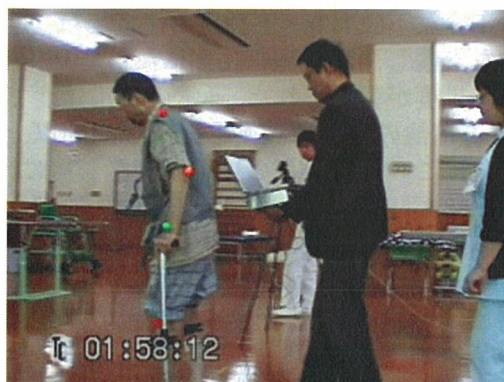
図 C-11 患者 4 の杖歩行での膝伸展力支援。外側広筋の EMG で大腿直筋への FES を制御。
