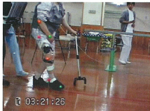
図 21. 患者 5 の杖歩行での膝伸展力支援（外側広筋の EMG で大腿直筋への FES を制御）
