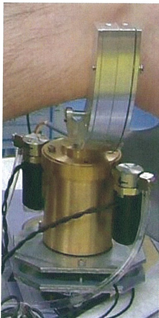
下腿底面から支持する固定治具の支持部分における上下水圧可動システム
