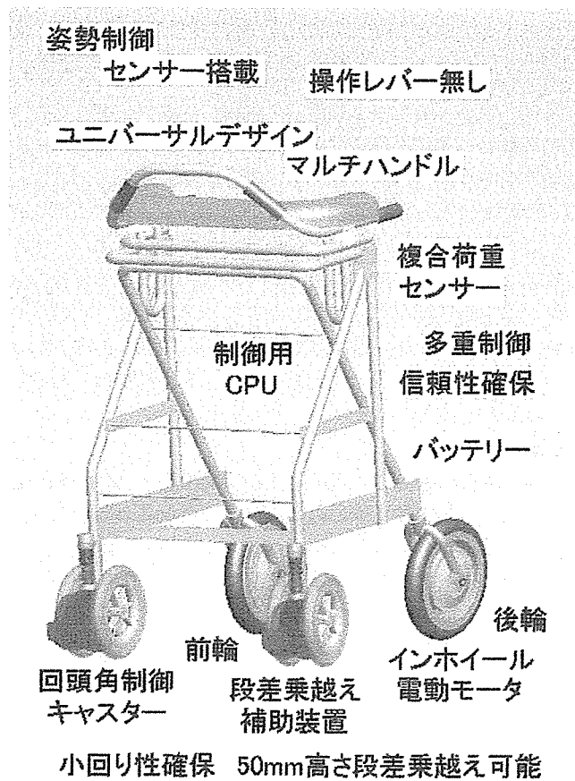
図 4.1 第3次歩行支援機試作機の概要
