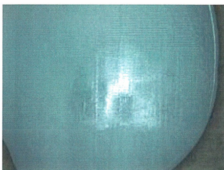
図 9-D. 人工膝関節シミュレーション試験 (100 万回)後の MPC 処理 CLPE インサート摺動部表面写真 (外顆側)
