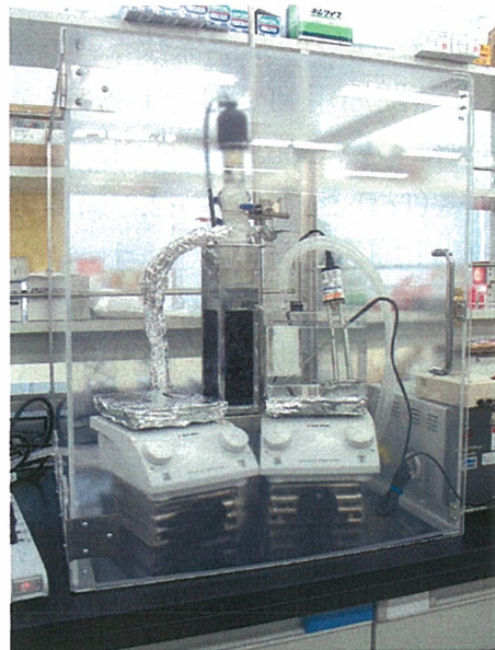
図 3-A. 人工膝関節用 MPC 処理 UHMWPE の MPC 処理 (装置全景)
