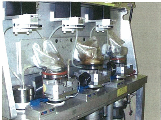
図 5. AMTI 社製 6 チャンネル人工膝関節シミュレーション試験装置
