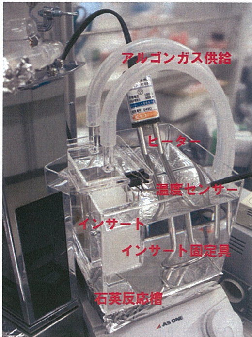
図 3-B. 人工膝関節用 MPC 処理 UHMWPE の MPC 処理 (処理槽拡大)
