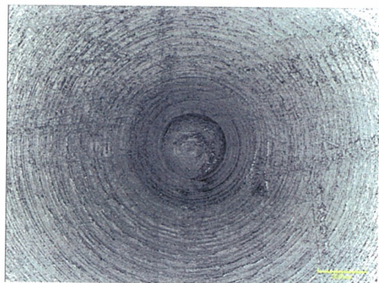
図 8. 人工股関節シミュレーション試験前の MPC ポリマー処理 CLPE ライナー摺動表面 LSM 像
