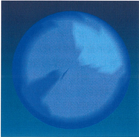
図 15-2. 人工股関節シミュレーション試験 500 万回後の MPC ポリマー処理 CLPE ライナー (MPC ポリマー処理 時間 23 分) 摺動面コンター図
