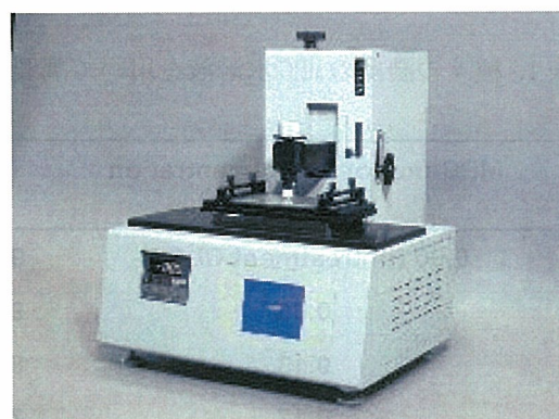
図 1. Ball-on-Flat 摩擦試験機
