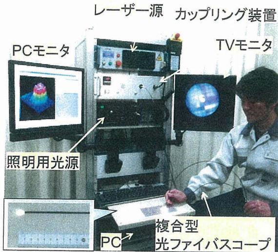
Fig.1 レーザー照射機能を有する極細径内視鏡(複合型光ファイバースコープシステム)
