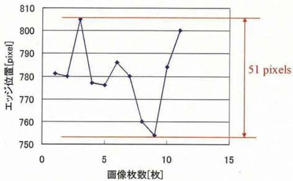
図 18 ハンドピース先端における振動振幅
