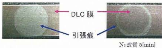
図35 DLC(Ti)の引張痕とラマン分析
