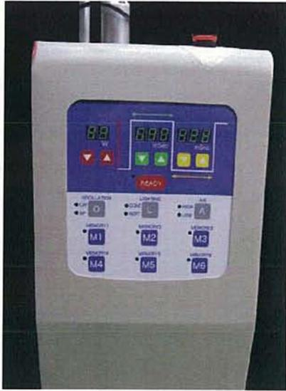
図4、ナノ振動接合装置 レーザー発生装置
