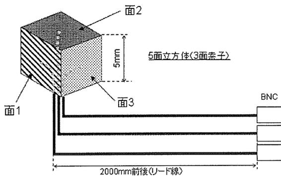
図 24 受信専用センサの概略図と寸法
