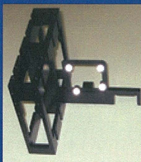
図IV-1 赤外線反射材を使用した座標軸のキャリブレーション治具
