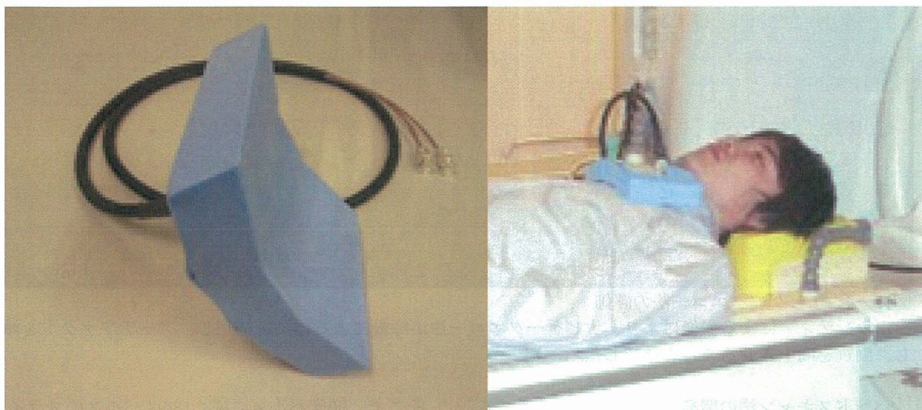
図II-2 頸部コイル（左）によるボランティアスキャン（右）
