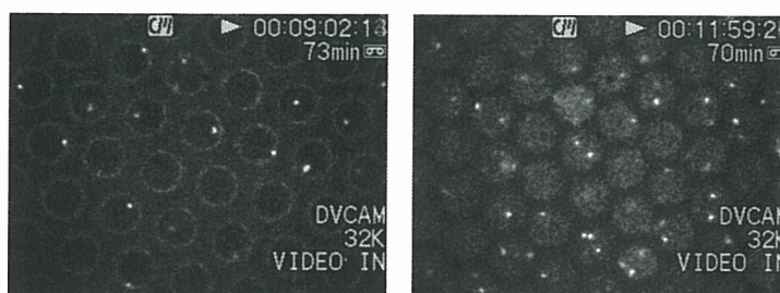
図1 マイクロチャンバーを用いた PCR1サイクル後のDNA増幅。 反応前(左)は0.5分子/チャンバーで あったのに対し、サイクル後は 0.8分子/チャンバーとなった。
