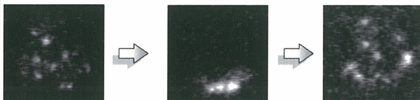
図5 チャンバー内DNAの電気的操作 通電によって自由に動いていたDNAが下方に寄せられ、通電の停止後は元のように自由にブラウン運動を続ける。
