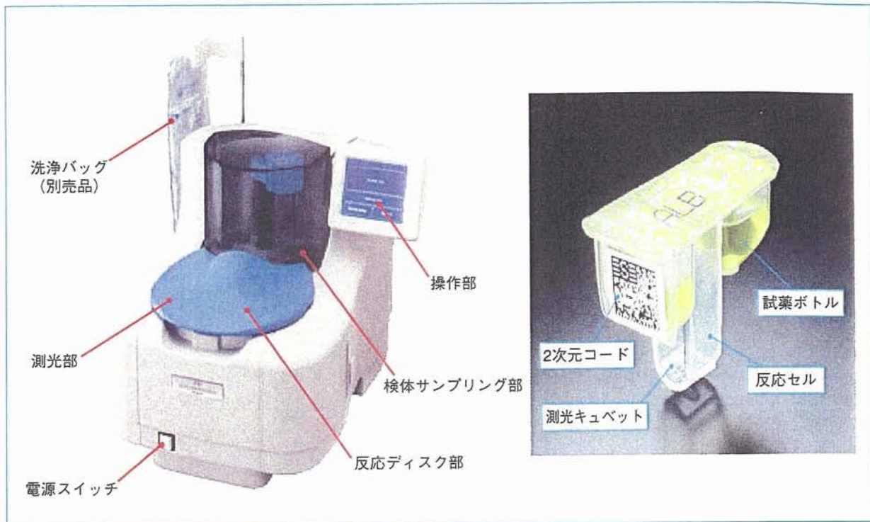
図5 日立製作所パーソナル・ヘルスケアベンチャーカンパニー製血液分析装置
