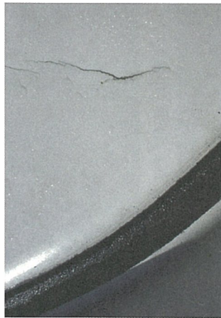
2-5改善前 本体の亀裂
