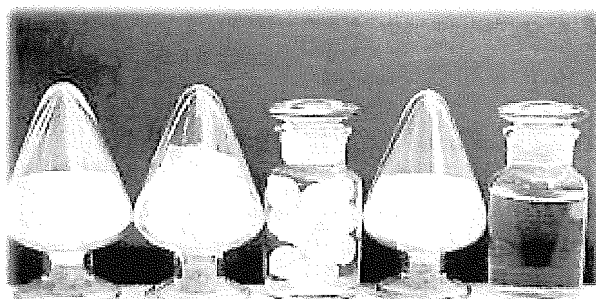
① 鱗片状 ② 塊状 ③ 球状 ④ 粉体状 ⑤ 液体状 写真 2-1 防錆剤の形態
