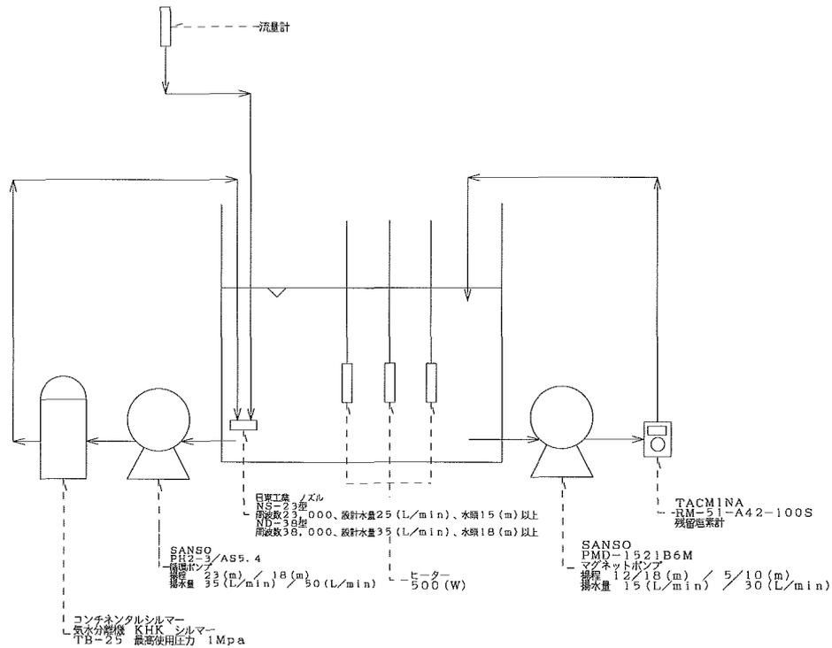
図 1.4.2 超音波浴槽の実験装置
