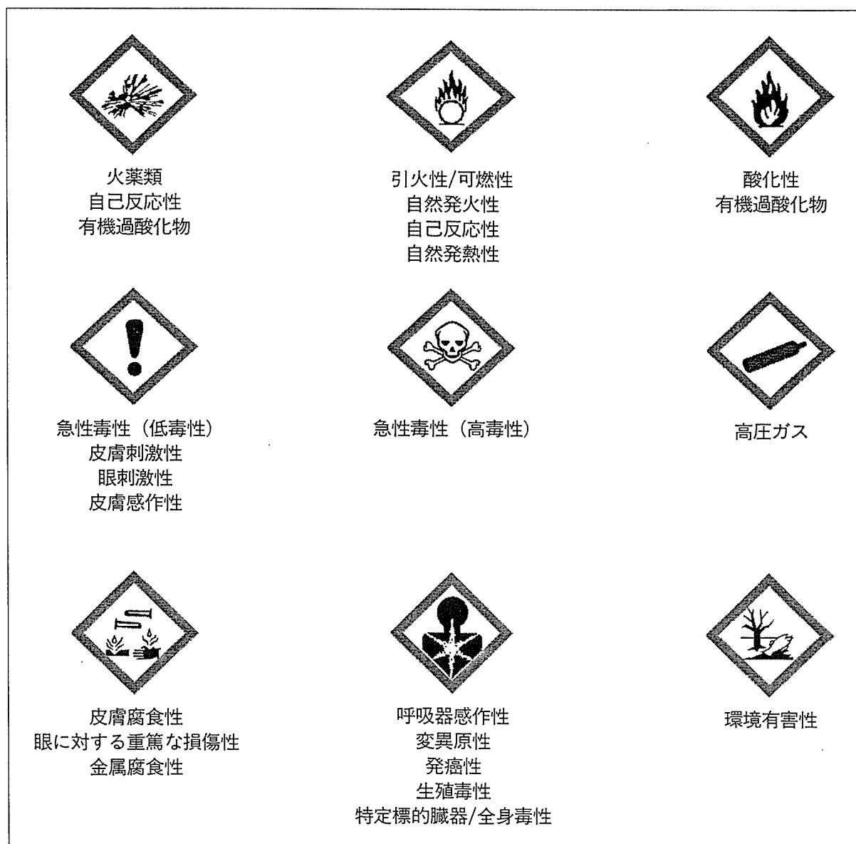
図1 危険有害性を表す絵表示 (菱形枠は赤色、中のシンボルは黒色が用いられる。危険有害性の種類、区分によって使用される絵表示が多少異なるので詳細はGHS文書を参照のこと)
