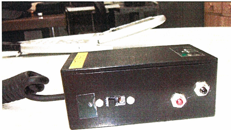
図 5-2 IC タグリーダのスイッチ 左からモード切替スライドスイッチ, 強制終了ボタン, 起動ボタン
