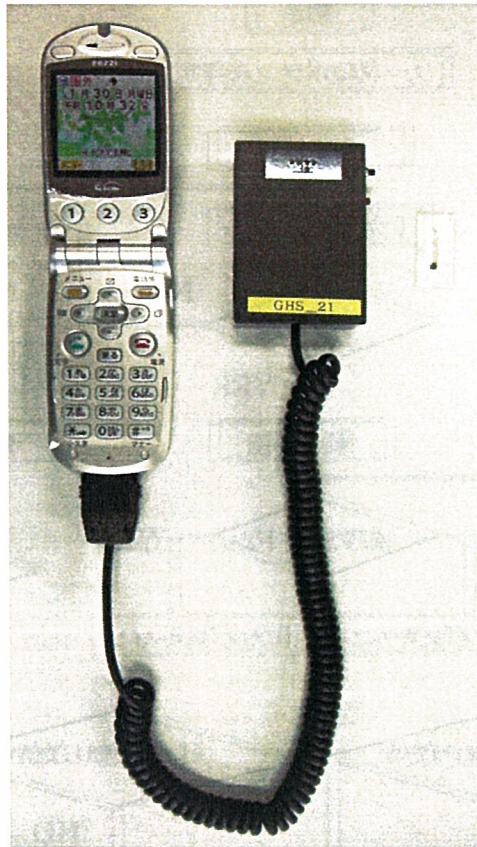
図 5-1 携帯電話 (左), IC タグ (右) と IC タグリーダ (中央)
