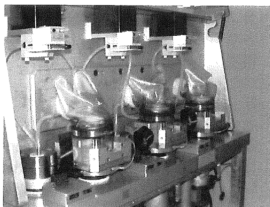
図6. AMTI 社製 6 チャンネル人工膝関節シミュレーター試験装置
