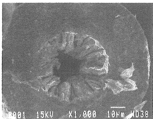
図 1 外径 100 \mu\text{m} 、内径 50 \mu\text{m} の Fe-24Cr-2Mo 細管の SEM2 次電子像
