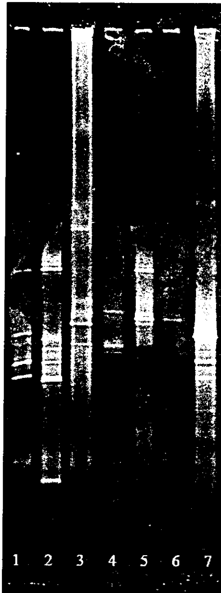
図6 水道原水と浄水場における各処理工程より得た試料水の DGGE 解析像
