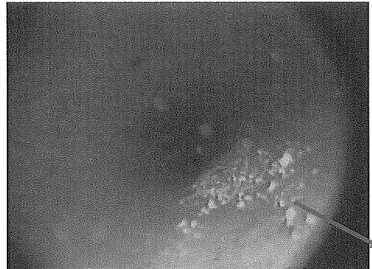
写真 5.2.2 濁質堆積状況 (φ 150、0.287m/s)
