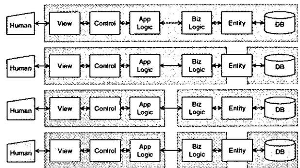
上段は Stand-alone, 他は C/S モデルであり、うち最下段は 3 階層アーキテクチャである。下二つはモジュール間 protocol の規定を要求することになる。最下段は、サーバの分散性が向上することになる。
