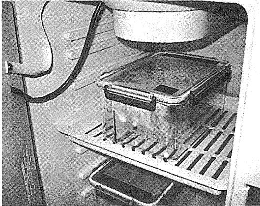
図3 ;ポータブルインキュベーターにWHOマイクロテストプレートを入れたアネロパック角形ジャーを入れるところ。角形ジャーは内部が間仕切りにより広さの異なる3つの小部屋に区別されている。一番広い空間にWHOマイクロテストプレートを設置し、残りの空間には、それぞれアネロパックと水を入れる。
