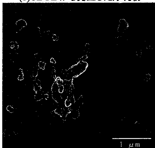
(c)MPC-CL-PE から発生した摩耗粉
