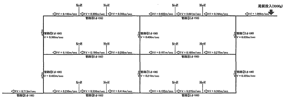
図-3-3-26 田型管網 (斜め注入/取出し) 実験流速分布
