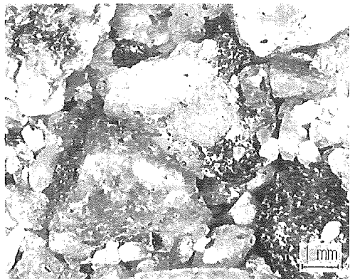
写真 2-2-1 大管用 CL 砂
