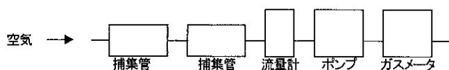
図-1.3.3 室内空気中のホルムアルデヒド（日常生活）の採取装置の一例
