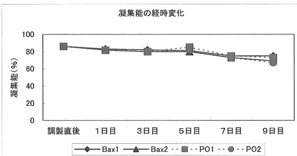
図 7 凝集能測定結果
