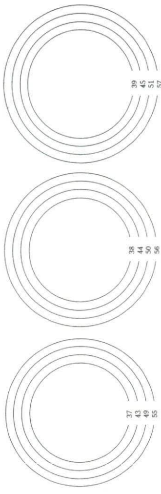
Stage 3判定用 圧潰測定ゲージ(1目盛り以上の圧潰はStage 3Bと判定する。)
