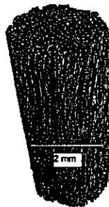
熱分解したブナに浸透した \text{SiO}_2 、ノル円柱のX線断層撮影像 (コンピュータ計算で描出した炭素部分)
