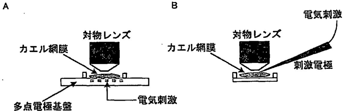
図 2. 電気刺激方法の概略図。A. 視細胞側刺激の方法。B. 神経節細胞側刺激の方法。
