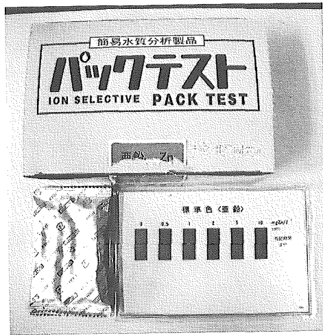
図3 亜鉛のパックテスト(左)と試験紙(右)
