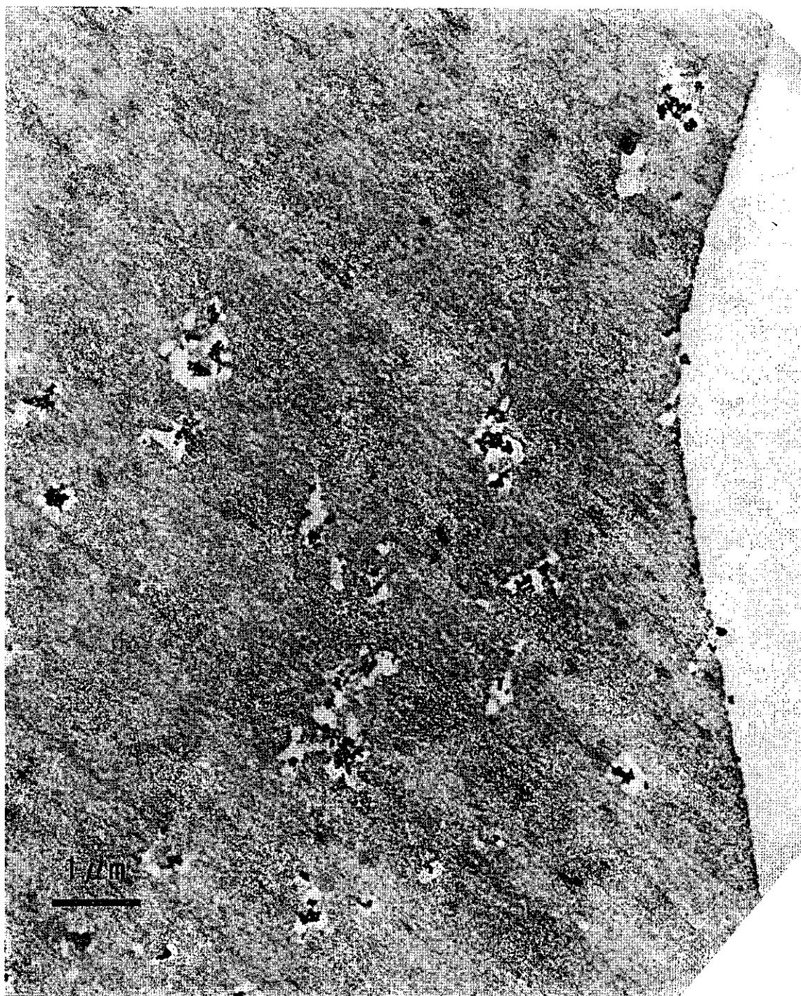
図 1. PMMA 包埋超薄切片法による塩ビ手袋の断面 TEM 写真
