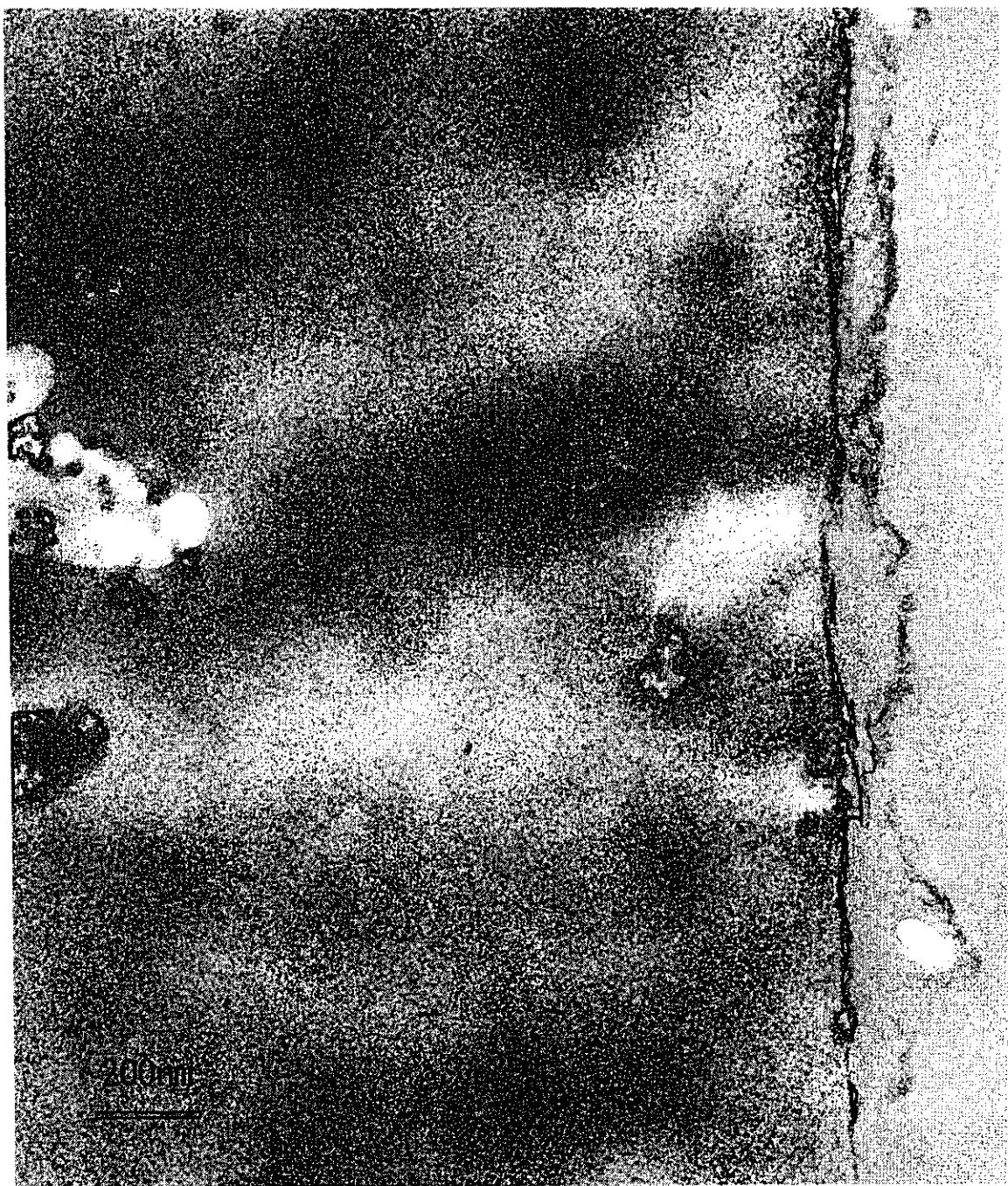
図 2. エポキシ包埋 RuO<sub>4</sub> 染色超薄切片法による塩ビ手袋の断面 TEM 写真
