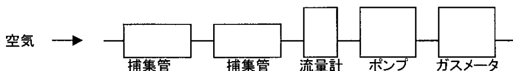
図-1.3.3 室内空気中のホルムアルデヒド（日常生活）の採取装置の一例
