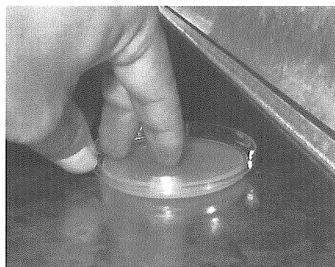
図 2-7 コンタクトプレートによる付着微生物測定
