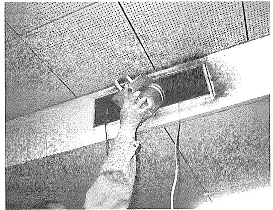
図 2-8 エアサンプラによる 浮遊微生物濃度測定
