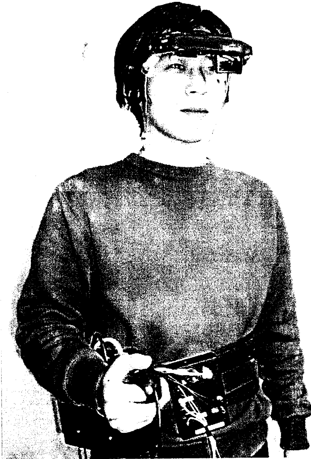
図2 試作したウェアラブルコンピュータシステムを使用している。HMD(ヘッドマウントディスプレイ)を出力とし、PHS 経由で、インターネット接続されている。
