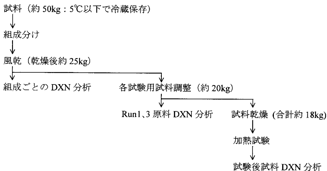
図 2.2-1 ごみの加熱試験フロー
