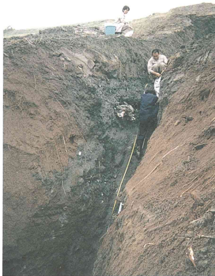
写真-11 下段部の直掘部サンプリング状況
