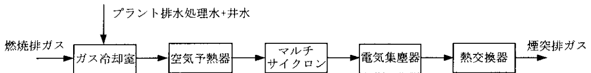
図 B-2-3 C市排ガス処理フロー
