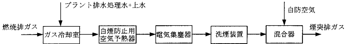
図 B-2-1 A市排ガス処理フロー
